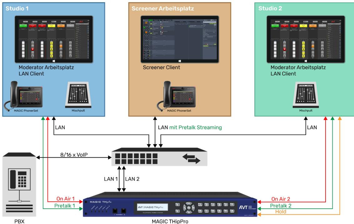
Diese Beispielapplikation zeigt **zwei Studios, die sich die gleichen Anruferleitungen teilen**. Beide Moderatoren arbeiten jeweils mit der MAGIC THipPro LAN Software. Jedes Studio hat eine eigene ON AIR-Audoleitung, d.h. beide Moderatoren können also gleichzeitig einen oder mehrere Anrufer auf ON AIR schalten. Jeder Moderator hat außerdem eine eigene PRETALK-Leitung, falls mit dem Anrufer ein Vorgespräch möglich sein soll.
